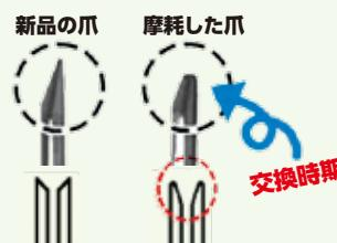
植付爪や植付部が正常に作動しないと、苗取り・植付け不良から水稻の品質・収量に悪影響を及ぼし、補植など余分な労力も増加します。
